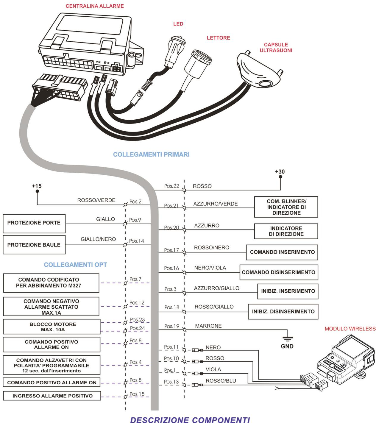
**Centralina allarme:** Costituisce l'unità elettronica principale del sistema d'allarme.
